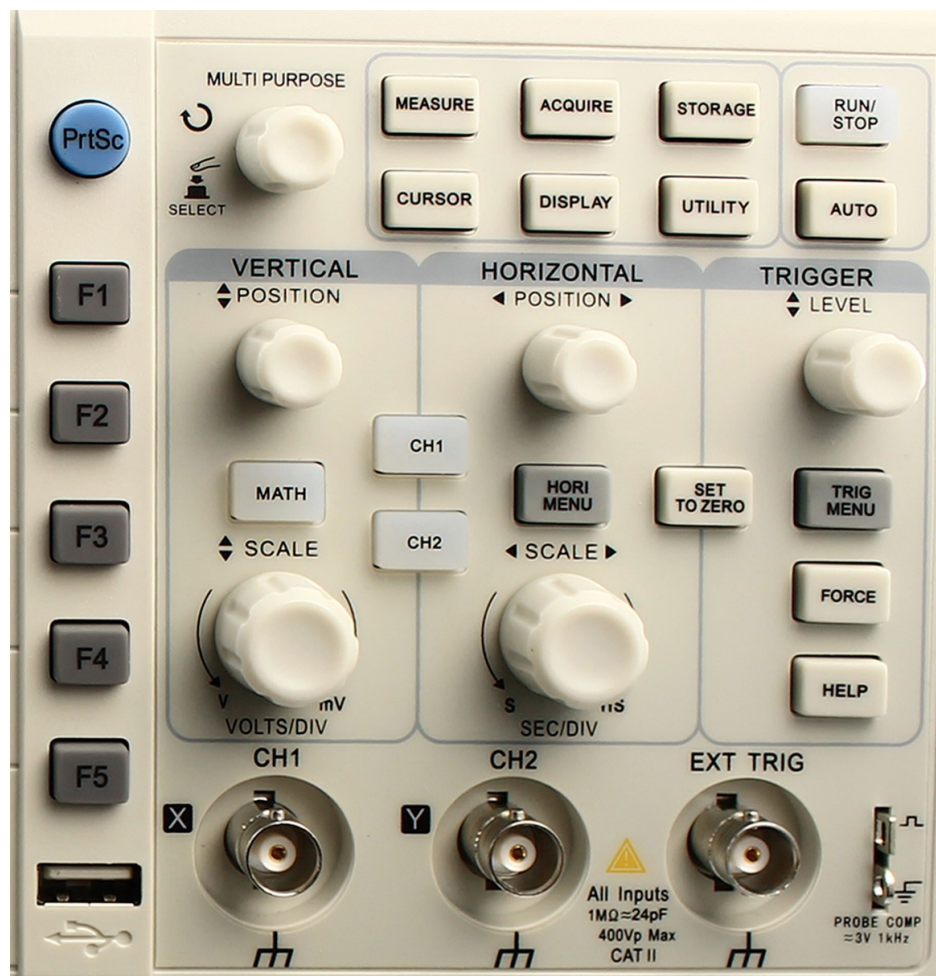
Фиг. 10. Клавиатура на осцилоскоп UTD2025CL.
