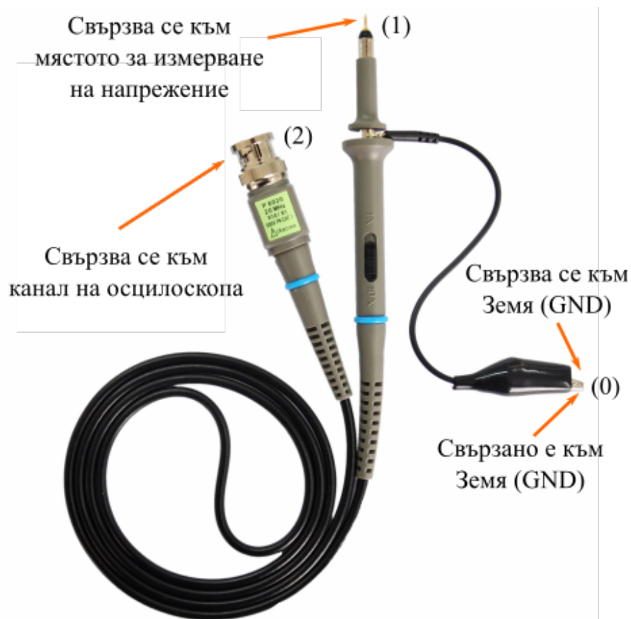
Фиг. 8. Измервателна сонда за напрежение на осцилоскоп.
