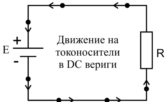
Фиг. 5.2. Движение на електрони при постоянен ток
