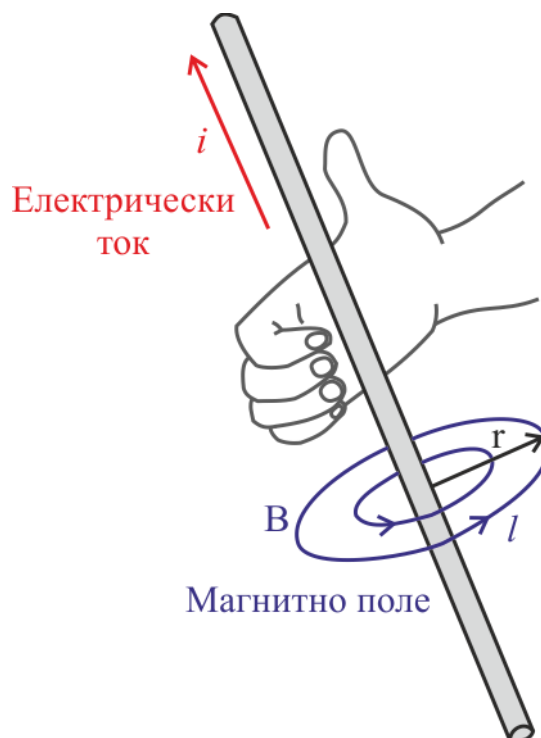
Фиг. 4.11. Правило на дясната ръка за магнитното поле около проводник
