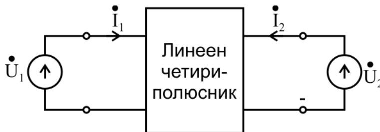
Фиг. 10.12. Схема на четириполюсник с два източника на напрежение
