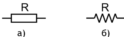
Фиг. 1.13. Условно означение на резистор в различните държави
