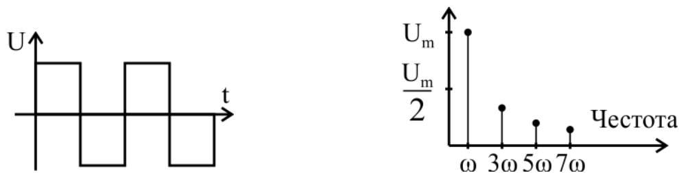
Фиг. 8.5. Времедиаграма и амплитуда на хармониците при правоъгълен сигнал
