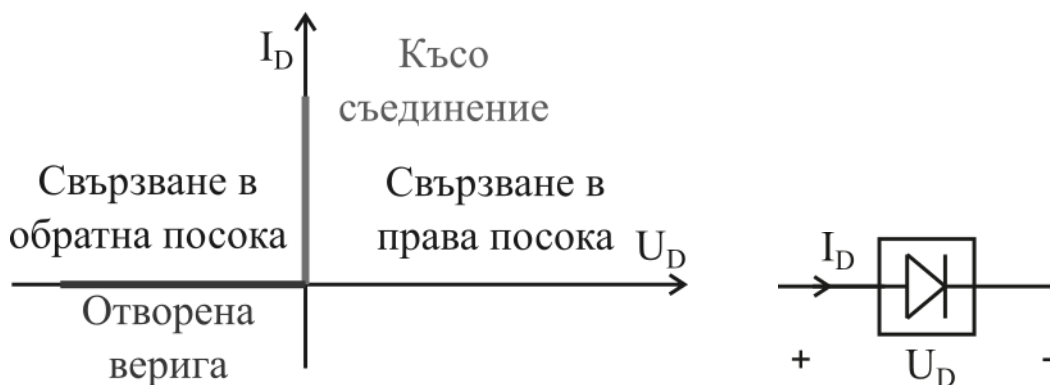
Фиг. 12.7. ВАХ (ляво) и условно означение на идеален диод (дясно)
