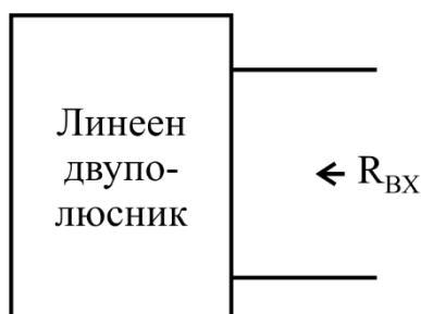
Фиг. 2.16. Определяне входното съпротивления на пасивния двуполуосник
