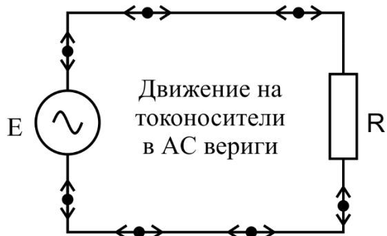
Фиг. 5.3. Движение на електрони при променлив ток
