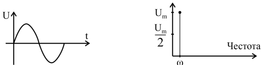
Фиг. 8.4. Времедиаграма и амплитуда на хармониците при синусоидален сигнал
