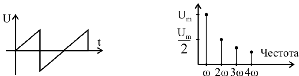
Фиг. 8.7. Времедиаграма и амплитуда на хармониците при трионообразен сигнал
