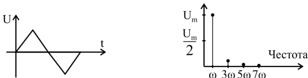
Фиг. 8.6. Времедиаграма и амплитуда на хармониците при триъгълен сигнал
