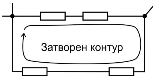
Фиг. 1.12. Затворен контур в електрическа верига
